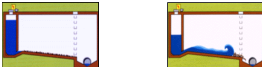
Slika 1-21: Zadrževalni bazen se po nevihti izprazni. Trdni delci, prineseni z meteorno vodo, sedimentirajo in onesnažijo tla zadrževalnika. Potem ko se izprazni ves bazen, se sproži sistem za izplakovanje. Zadržana voda sunkovito odteče iz prekata. Močan val učinkovito oplakne dno bazena.
