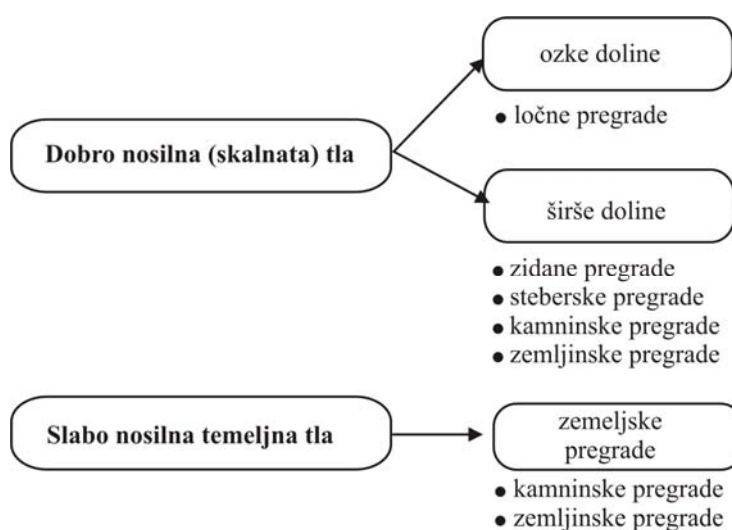
Slika 2-16: Primernost posameznih tipov pregrad glede na nosilnost tal
