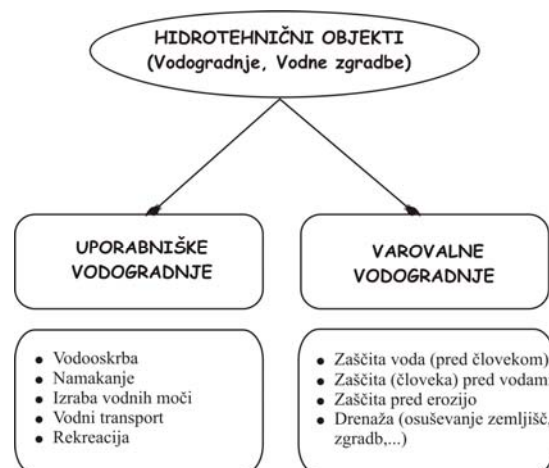
Slika 2-2: Delitev hidrotehničnih objektov glede na namen
