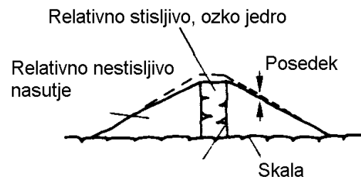
Slika 3-13: Razpoke v jedru zaradi ločnega učinka pri različnih posedkih
