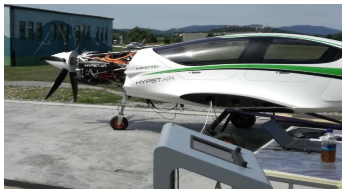
Testiranje hibridnega pogonskega sklopa ultralahkega letala
