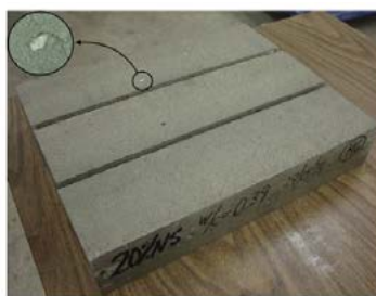
Prizme z 0 % in 2 % (desno) nano silike po 324 ciklih zmrzovanja in taljenja (w/c=0,39)
