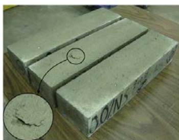
Prizme z 0 % in 2 % (desno) nano silike po 324 ciklih zmrzovanja in taljenja (w/c=0,39)
