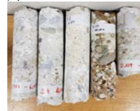
Horizontalne vrtnice iz jet grouting slopov (Zavarovanje gradbene jame A-Tower, Lj)
