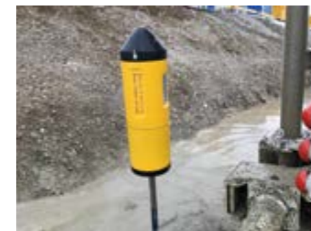
Akustični senzor za določanje premera JG slopa po ACI® metodi
