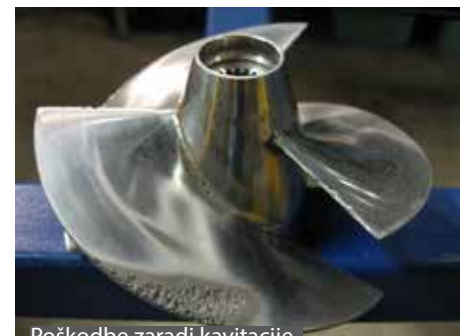
Poškodbe zaradi kavitacije
