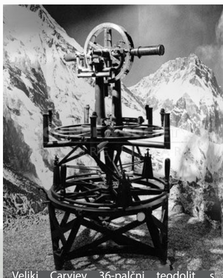
Veliki Caryjev 36-palčni teodolit, s katerim je William Lambton leta 1802 začel izmero velikega meridianskega loka na jugu Indije in s katerim je George Everest nadaljeval njegovo delo vse do vznožja Himalaje
