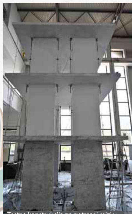
Testna konstrukcija na potresni mizi v Skopju
