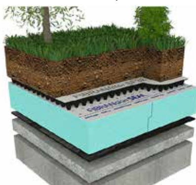
Konstrukcijski sklop zelene strehe
