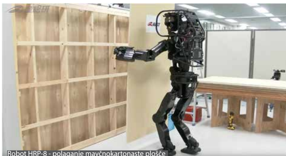
Robot HRP-8 - polaganje mavčnokartonaste plošče
