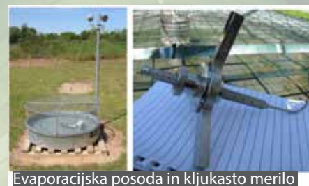
Evaporacijska posoda in kljukasto merilo
