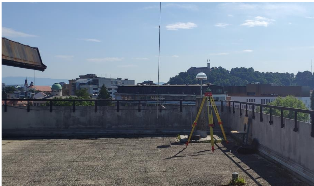
Slika 52: Stalna postaja na strehi Fakultete za gradbeništvo in geodezijo, točka FGG3 ter dodatno izmera spektrov s sprejemnikom u-blox ZED-F9P.
