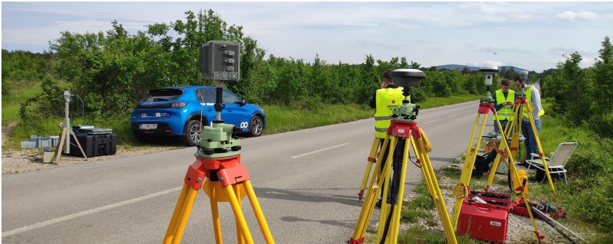
Slika 81: Črnotiče, 15/05/2015: izmera z geodetskimi sprejemniki (spreda) z namernimi motnjami signalov
