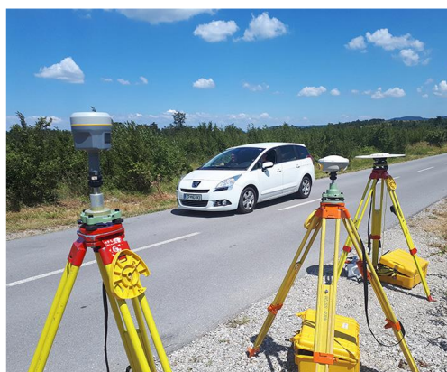
Slika 47: (levo) V vozilu nameščeni motilnik povzroča kinematične motnje mirujočim obcestnim sprejemnikom, (desno) Značilni presihci povprečij CNR vseh trenutno zaznanih satelitov, posneti z geodetskim sprejemnikom Javad Triumph LSA pod vplivom motenj na področju L1, ki jih je povzročal motilnik v mimovozečem vozilu.
