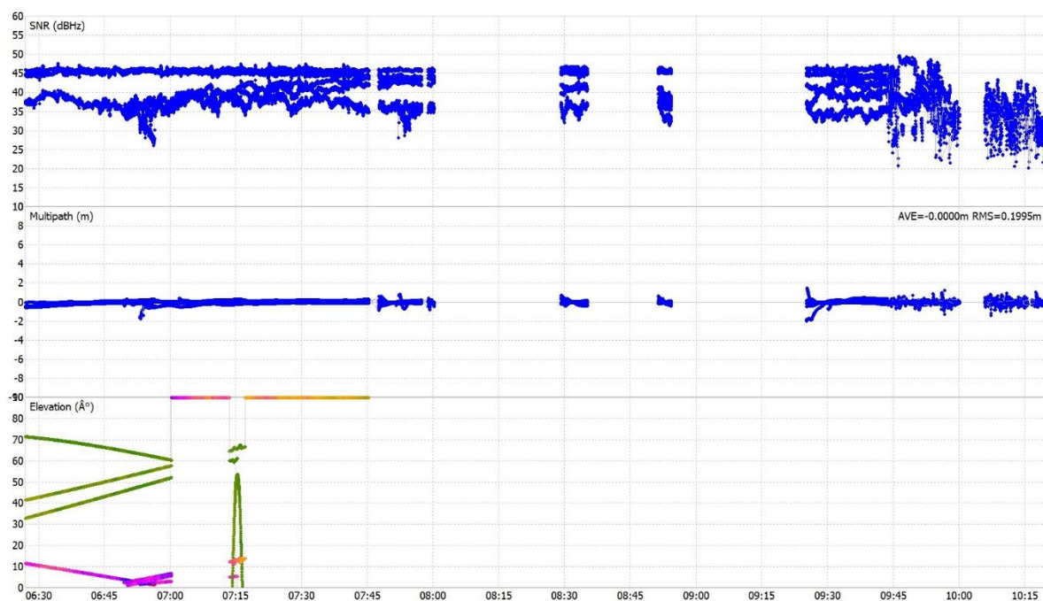
Slika 111: Črnotiče, 15/05/2024, Leica GS15, izris vrednosti SNR, odboja in višinskega kota za GLONASS, G2
