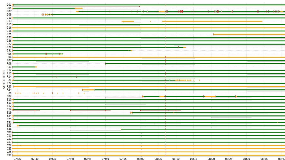
Slika 57: FGG3, 28/06/2024, 07:25 – 08:40 UTC. Signali vidnih satelitov vseh konstelacij z oznakami za skoke signalov (rdeče črtice); sprejemnik ZED-F9P.
