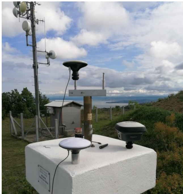
Slika 69: Malija 26/04/2024, izvedba preizkusa sprejemnikov po standardu ISO17123-8.
