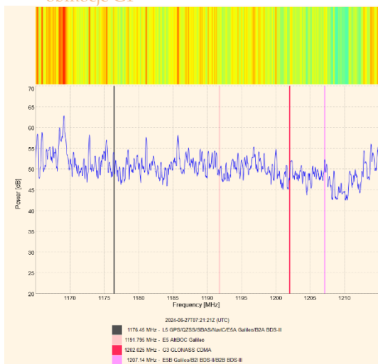
(c) izris L5 z označenimi frekvencami: L5, E5a/b, G3, (E5b, E5AltBOC, B2I, B2b)
