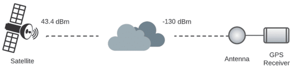
Slika 7: Signali GNSS so na poti od satelita do antene sprejemnika oslabljeni [28].
