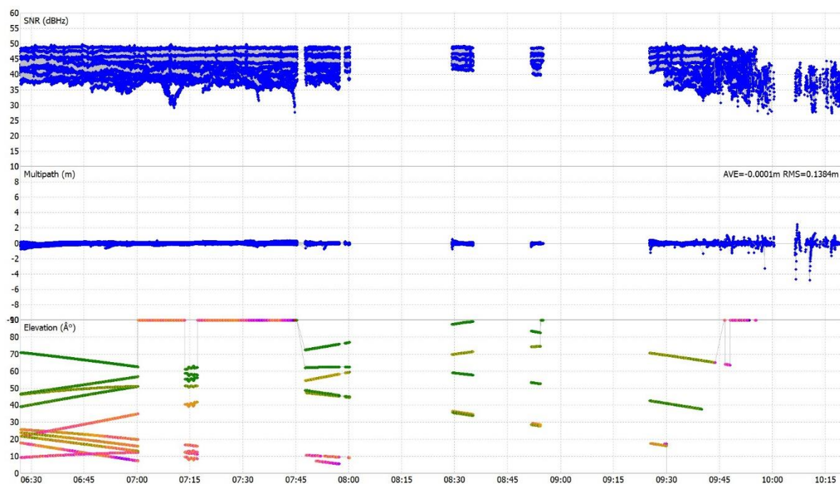
Slika 114: Črnotiče, 15/05/2024, Leica GS15, izris vrednosti SNR, odboja in višinskega kota za Galileo, E5a
