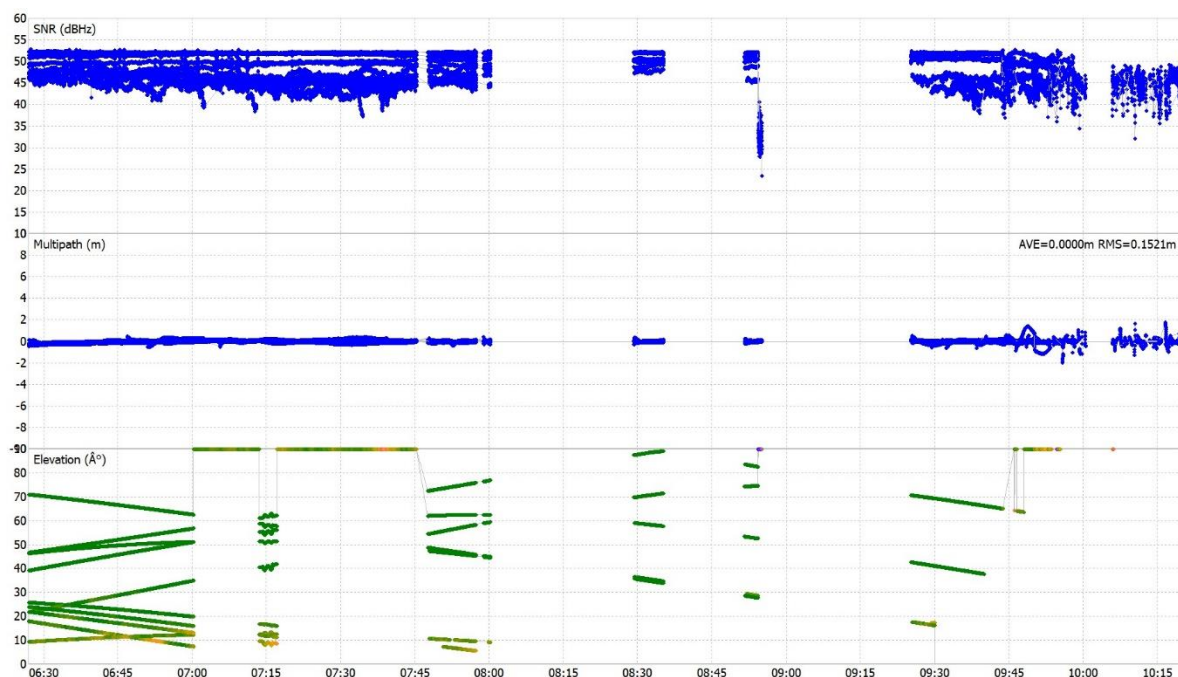
Slika 109: Črnotiče, 15/05/2024, Leica GS15, izris vrednosti SNR, odboja in višinskega kota za Galileo, E1
