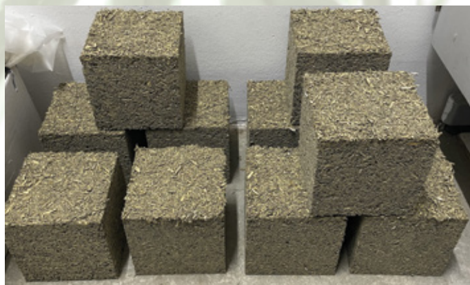
Kocke konopljinega betona (CoGreen)
