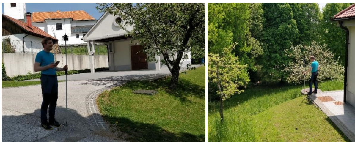
Slika 37: Interpretacija in izmera položajev NRP po meji objekta in brežine (vzhodni rob NRP).
