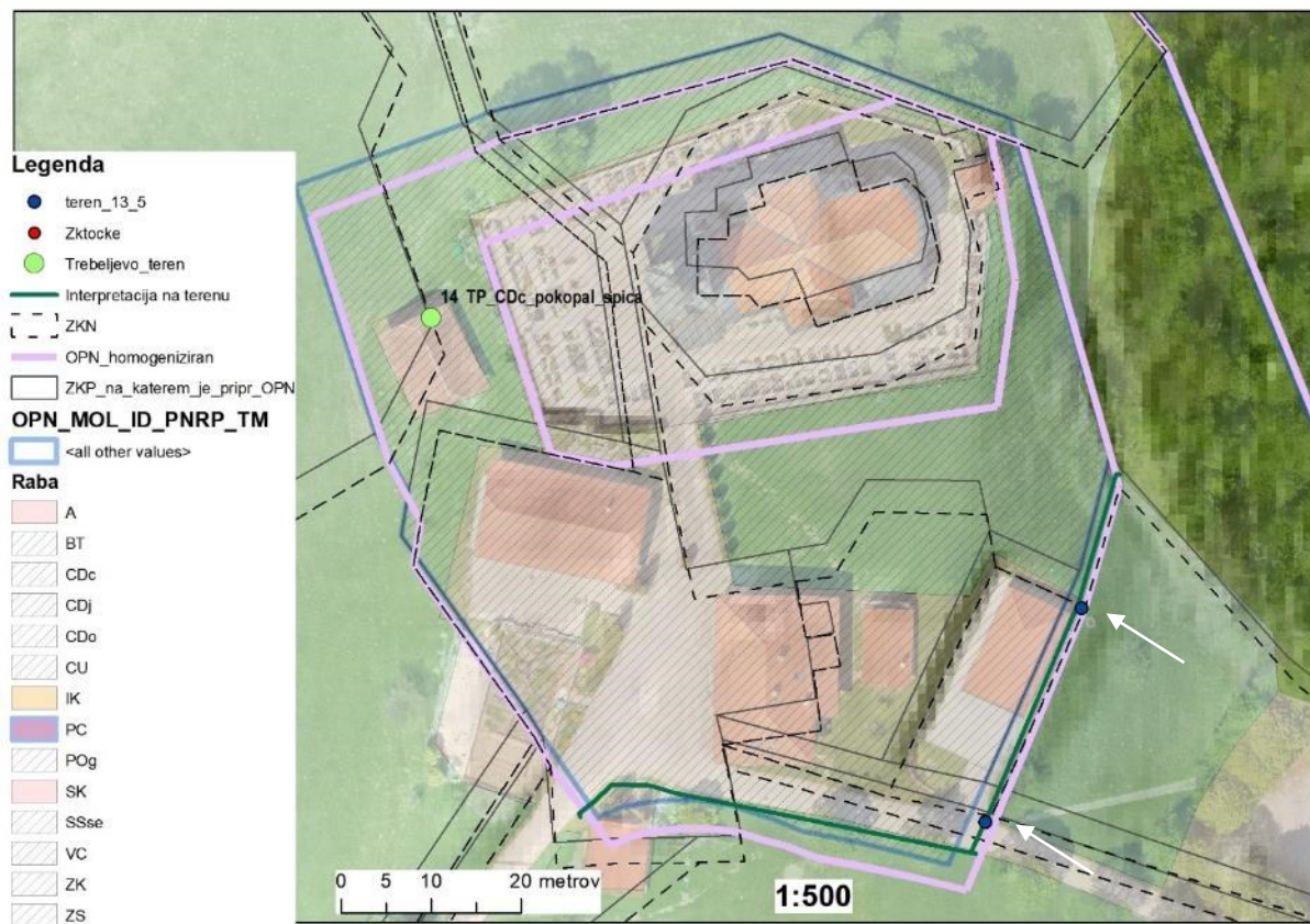
Slika 36: Na vzhodnem robu smo interpretirali NRP po meji objekta in brežine, kar je sovpadalo z veljavno NRP in tudi z NRP po izvedeni homogenizaciji.
