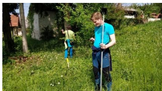
Slika 30: Določitev lomov meje NRP po robu objekta z izmero »pravega« položaja
