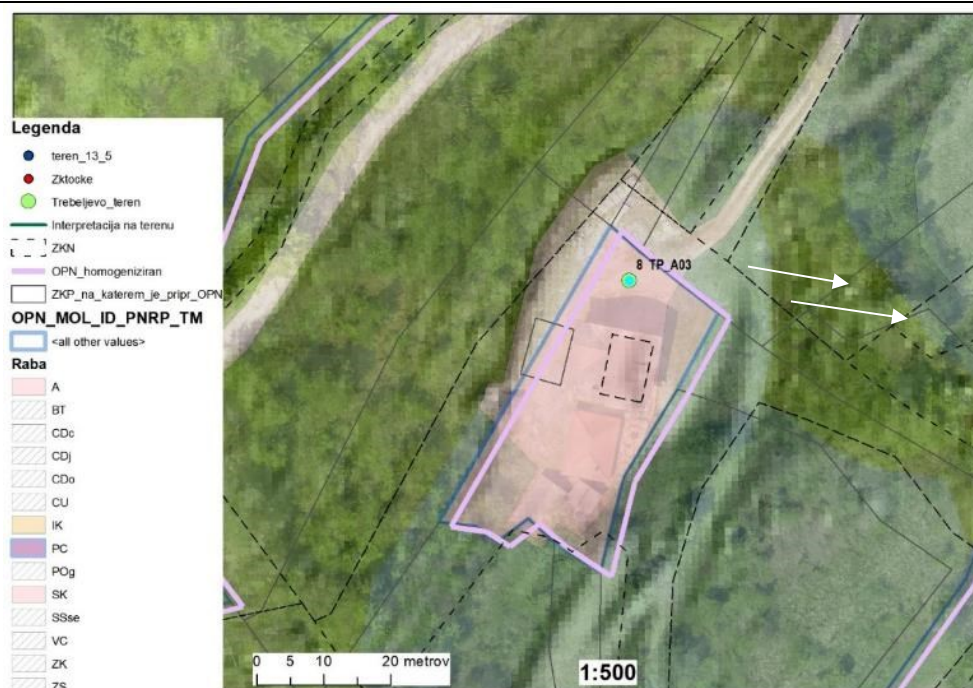
Slika 22: Homogenizirana NRP (roza črta) je ustrezna. Velik premik NRP iz ZKP na ZKN bi bil neustrezen.
