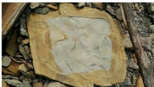
Slika 4.1: Preperevanje peščenjaka; notranji nepreperel del je sive barve, zunanji preperel rob rumenorjave (levo). Preperevanje laporovca (desno).
