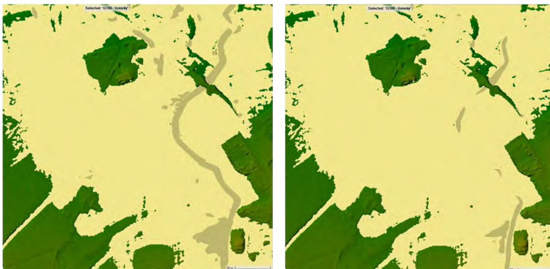
Slika 9.6: Primerjava erozijske nevarnosti pri poplavnem dogodku s konico pretoka Q_{100} glede na kriterij debeline odplavljenega erodiranega materiala in ob upoštevanju mejne vrednosti pretočne hitrosti 1 m/s (levo) ter mejne vrednosti strižne napetosti 50 N/m 2 (desno). Skladno s Pravilnikom temno peščena barva prikazuje debelino odplavljenega erodiranega materiala od 0,5 do 2,0 m, svetlo peščena barva pa debelino odplavljenega erodiranega materiala < 0,5 m.
