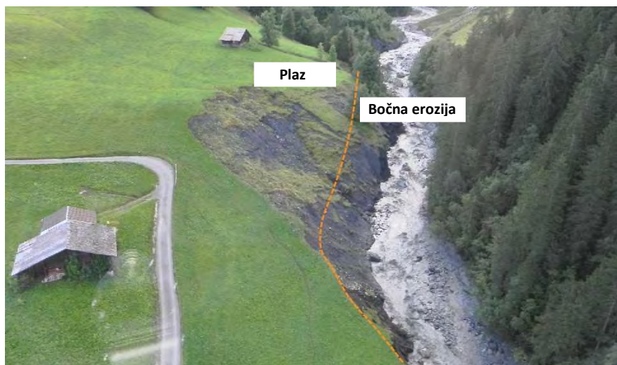
Slika 6.13: Primer razmejitev procesov bočne erozije brežin rečne struge in območja zemeljskega plaz (FAN, 2015).
