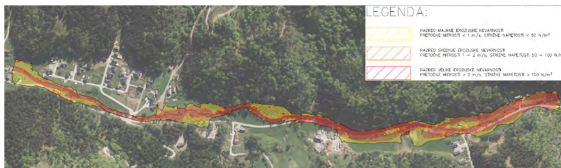
Slika 10.6: Primer ocene razredov erozijske nevarnosti (upoštevanje kriterija odplavljanja materiala) ob upoštevanju maksimalnih hidravličnih obremenitev iz hidravlične simulacije.
