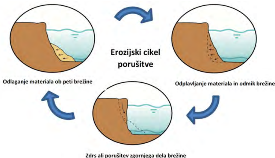
Slika 1.2: Mehanizem zdrs ali porušitev zgornjega dela brežine (prirejeno po Duro in sod., 2018).
