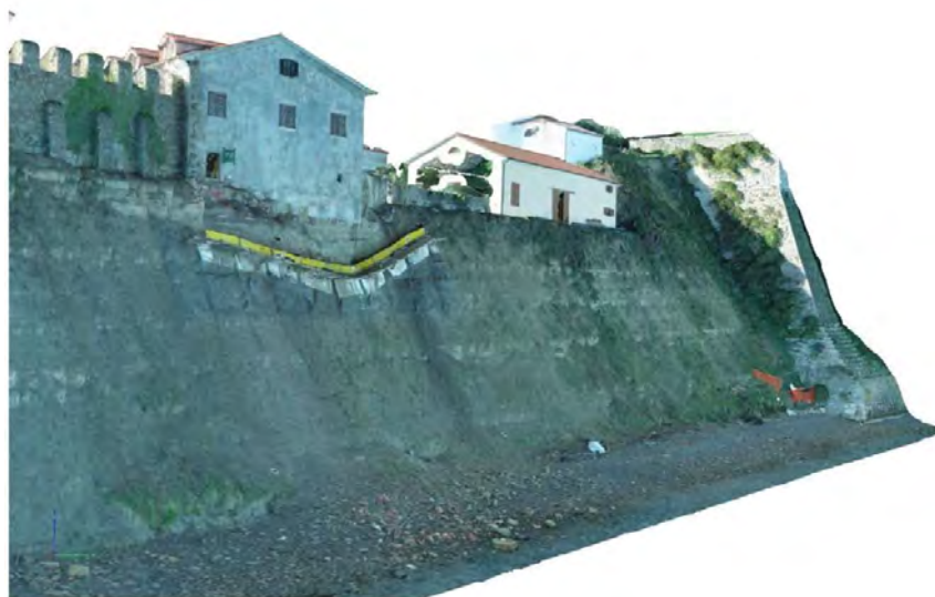
Slika 6.15: Primer 3D modela klifa v Piranu, narejenega z brezpilotnim letalnikom (avtor modela: K. Kozmus Trajkovski). Pod hišo župnišča (levo), ki je bila v fazi sanacije, so na vznožju vidne geodetske tarče.
