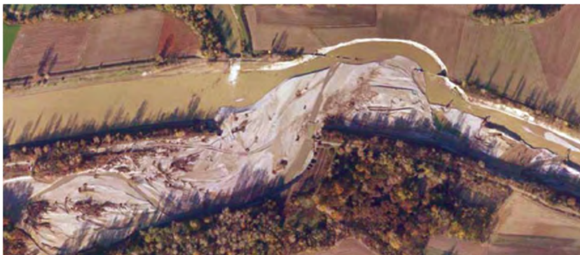
Slika 5.6: Odložene plavine v odvodnem kanalu HE Formin (Vir: Mensuras)
