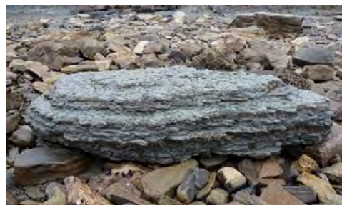
Slika 4.1: Preperevanje peščenjaka; notranji nepreperel del je sive barve, zunanji preperel rob rumenorjave (levo). Preperevanje laporovca (desno).
