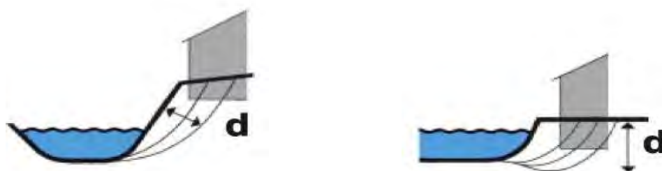
Slika 6.7: Razlika med zdrsom brežine (levo) in premikom rečne struge (desno) (Loat in Petrascheck, 1997)
