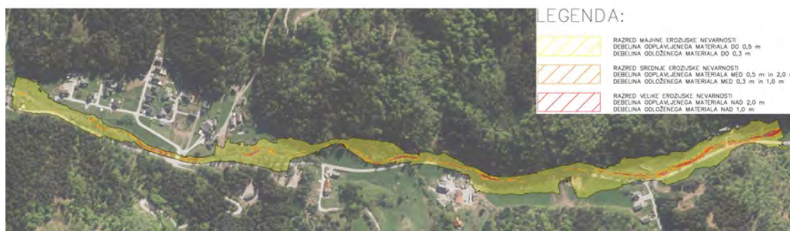
Slika 10.7: Primer ocene razredov erozijske nevarnosti ob upoštevanju rezultatov 2D modela premeščanja plavin.
