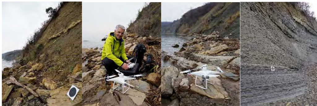
Slika 6.14: Snemanje obalnih klifov v okolici Strunjana z brezpilotnim letalnikom (na fotografiji M. Vrabec, BPL DJI Phantom 4 RTK in geodetske tarče; avtor fotografij: T. Verbovšek).
