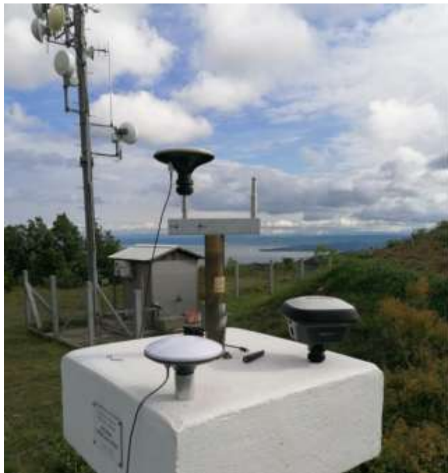
Slika 69: Malija 26/04/2024, izvedba preizkusa sprejemnikov po standardu ISO17123-8.
