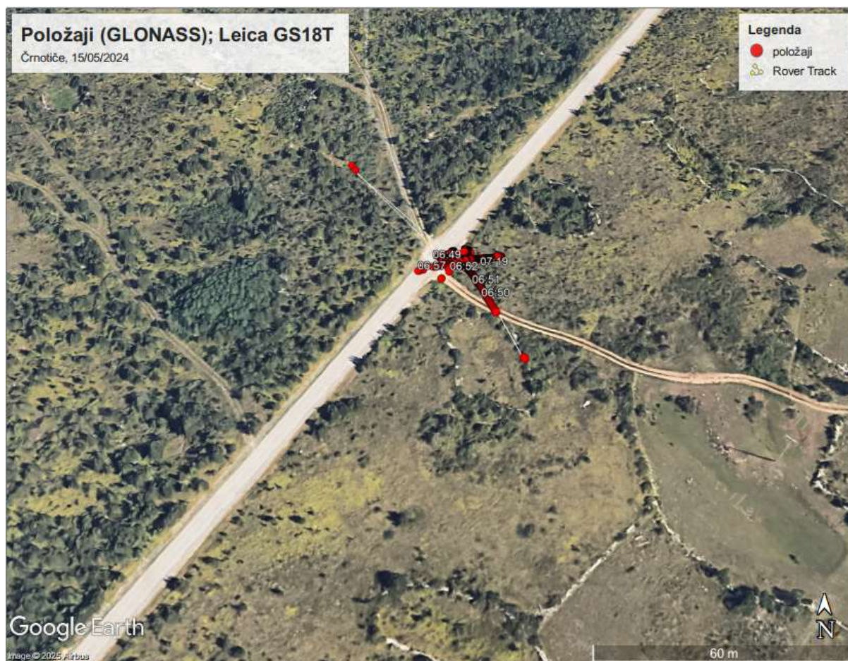
Slika 144: Črnotiče, 15/05/2024 Leica GS18T, SPP-položaji, GLONASS, podlaga Google Earth
