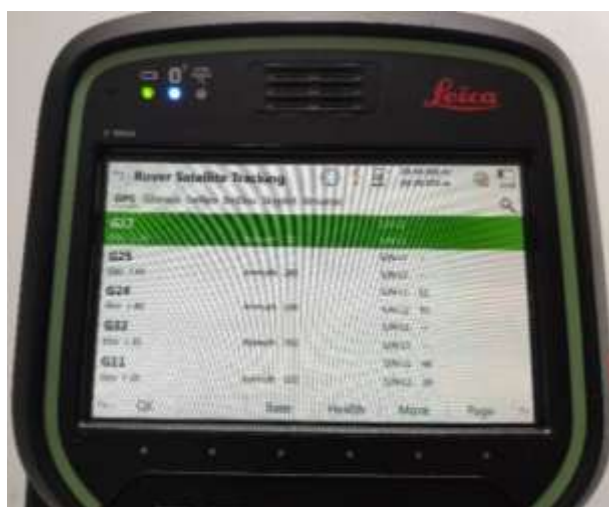
Slika 31: Spremljanje vrednosti SNR v realnem času (sprejemnik Leica GS18T).
