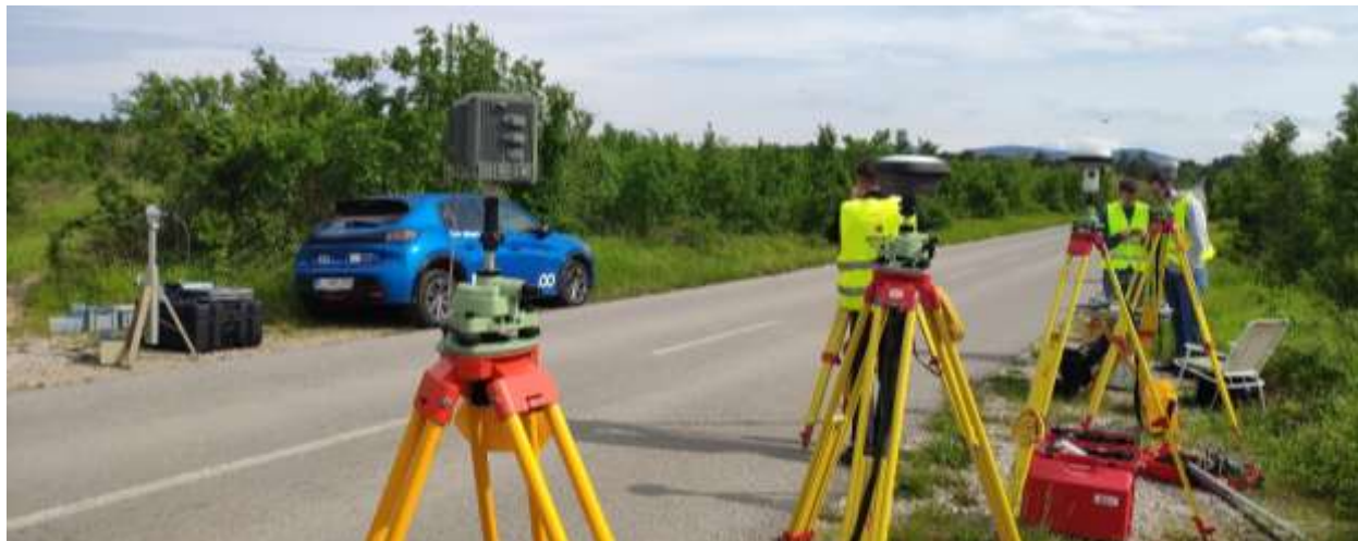
Slika 83: Črnotiče, 15/05/2015: izmera z geodetskimi sprejemniki (spreda) z namernimi motnjami signalov
