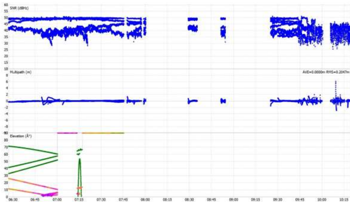
Slika 115: Črnotiče, 15/05/2024, Leica GS15, izris vrednosti SNR, odboja in višinskega kota za GLONASS, G1
