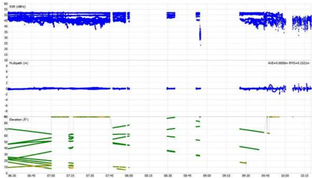
Slika 116: Črnotiče, 15/05/2024, Leica GS15, izris vrednosti SNR, odboja in višinskega kota za Galileo, E1
