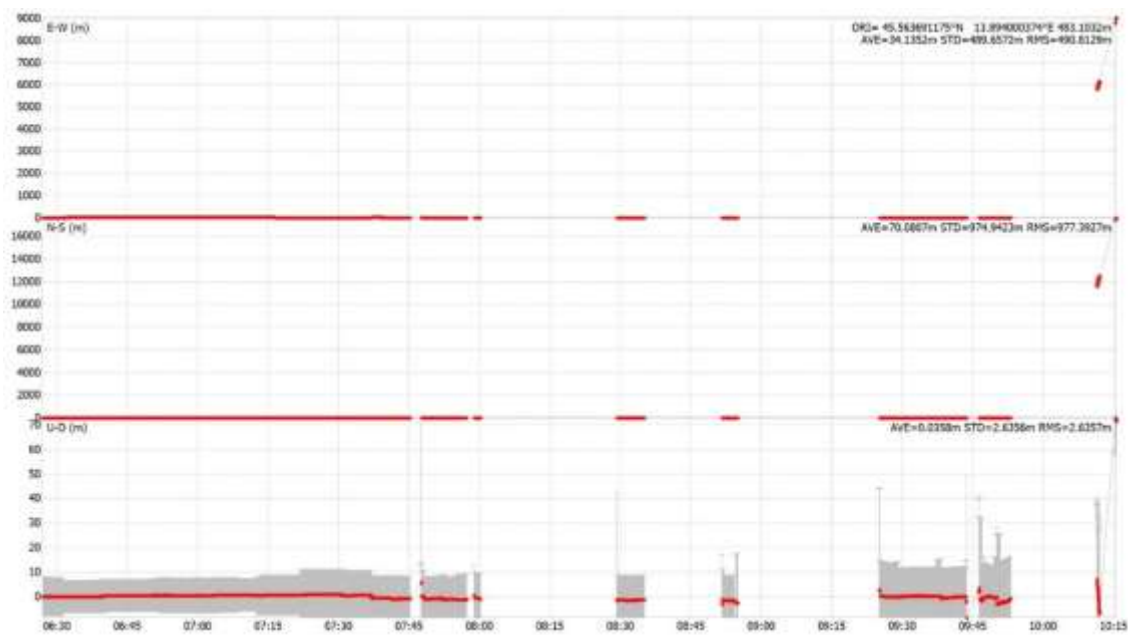
Slika 126: Črnotiče, 15/05/2024, Leica GS15, SPP-položaji, Galileo
