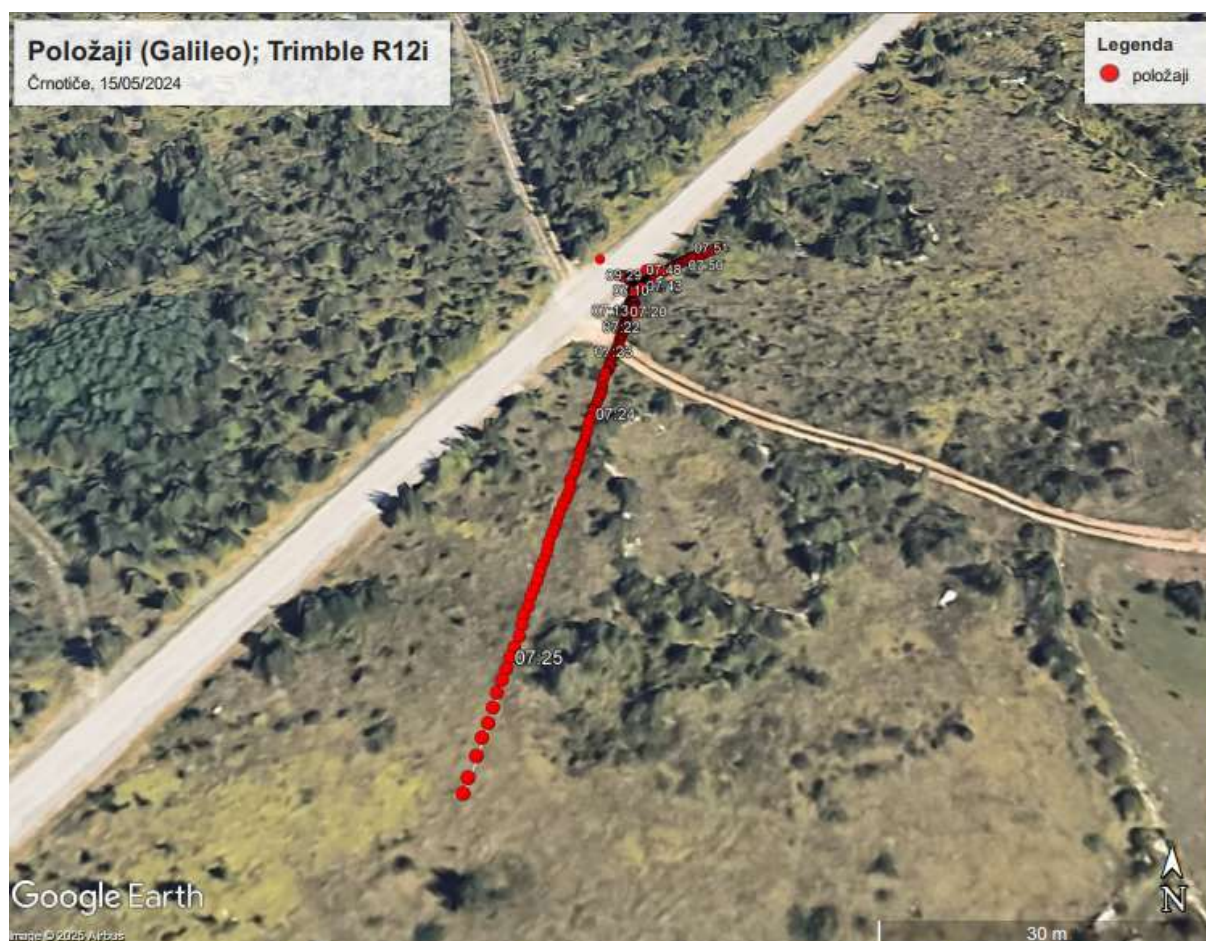
Slika 169: Črnotiče, 15/05/2024, Trimble R12i, SPP-položaji, Galileo, podlga Google Earth
