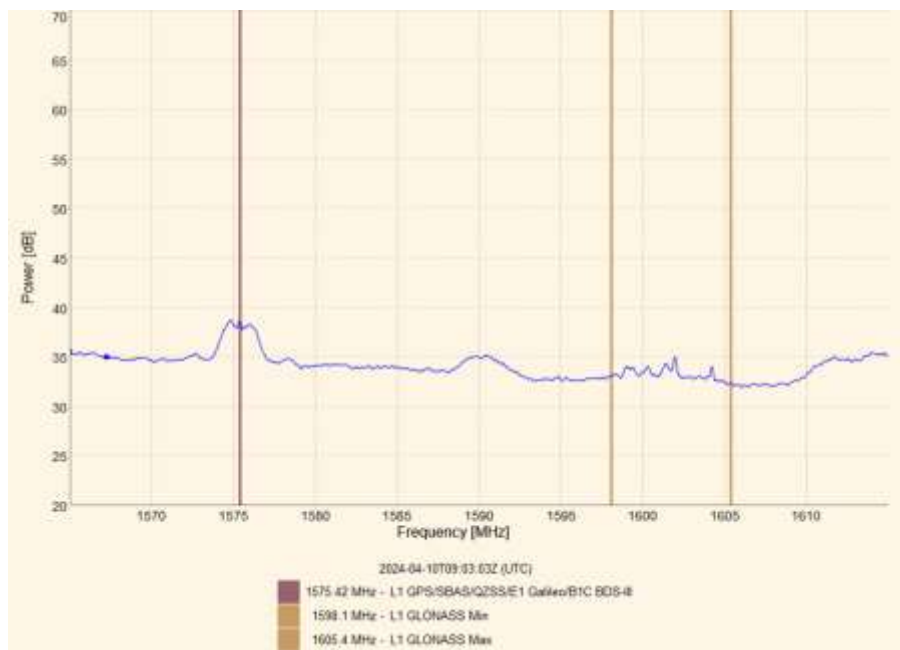
Slika 24: Spekter iz sprejemnika Trimble Alloy, način "Filtered".
