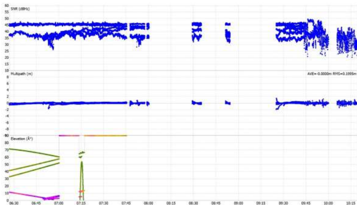
Slika 118: Črnotiče, 15/05/2024, Leica GS15, izris vrednosti SNR, odboja in višinskega kota za GLONASS, G2
