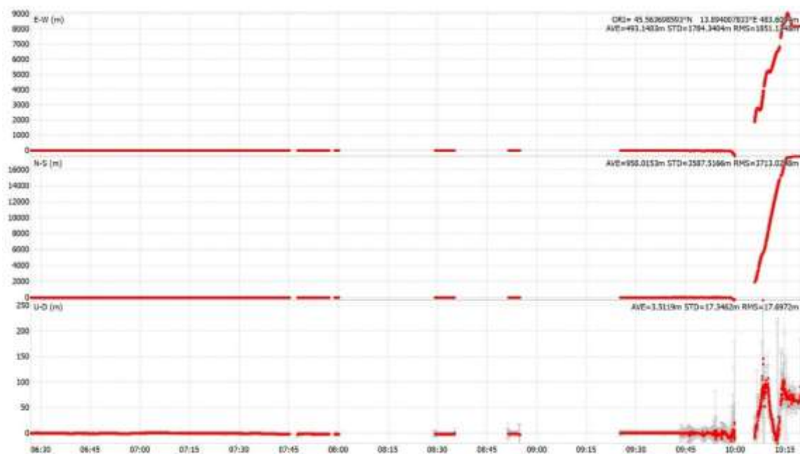
Slika 128: Črnotiče, 15/05/2024, Leica GS15, SPP-položaji, GPS + GLONASS + Galileo
