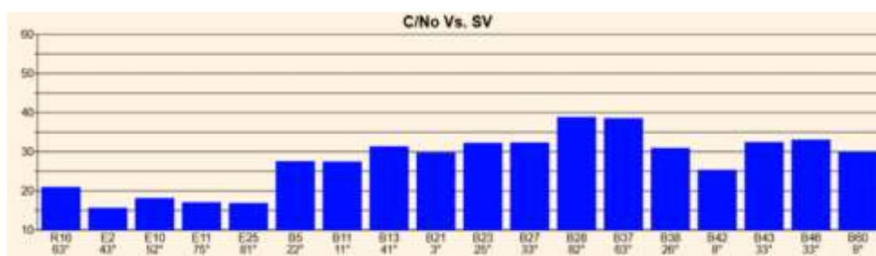
Slika 91: Črnotiče, 15/05/2024: vidni satelit v času motnje z motilnikom Keysight N5182B.
