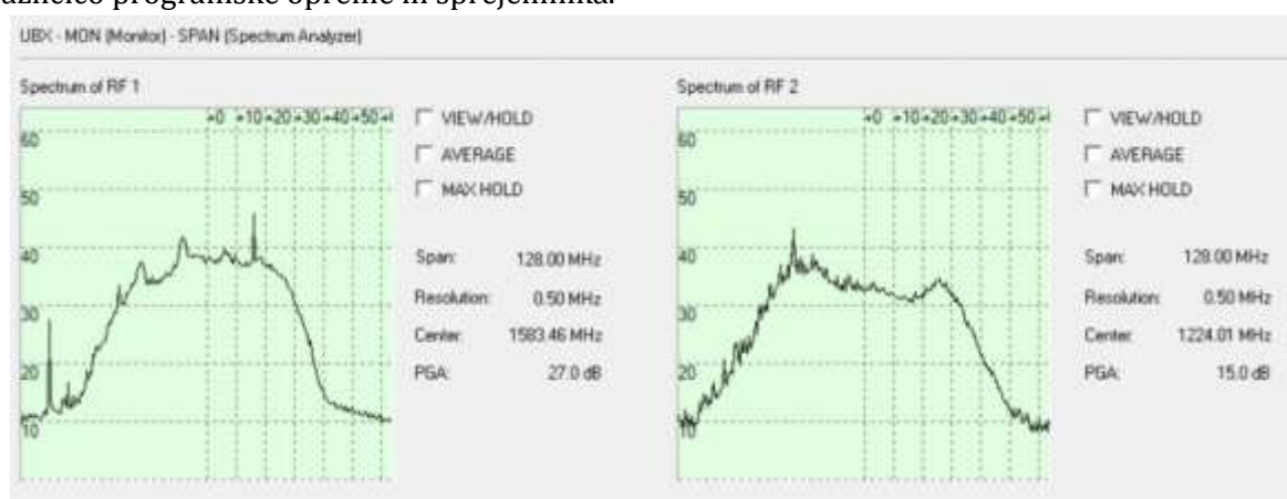
Slika 34: Spremljanje spektra signalov GNSS v realnem času s sprejemnikom ZED-F9P, program u-center.
