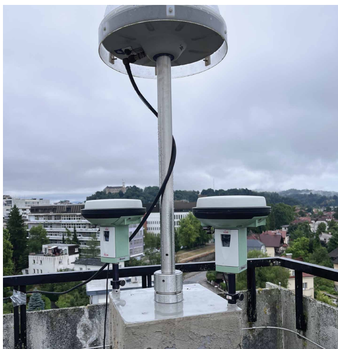
Slika 1: Statična izmera GNSS na stebri FGG3 (Samo Vetrih)
