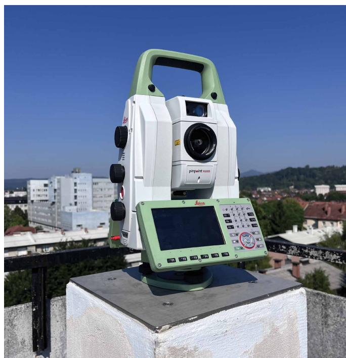
Slika 2: Tahimeter Leica Nova TS60 Total Station (Samo Vetrih)
