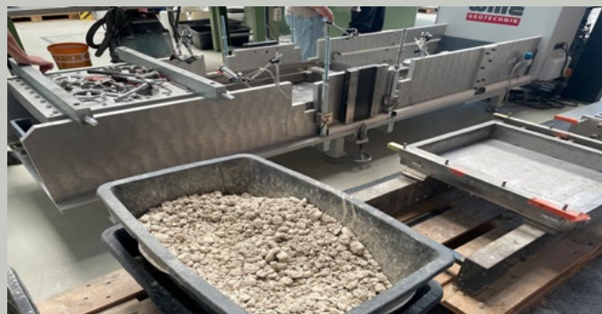
Slika 5: Strižni aparat z dimenzijami 500 mm x 500 mm in material (Vir: Hana Huth Lukšič)
