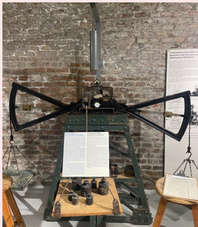
Slika 5: Aparat za dunajski rutinski strižni preizkus (Vir: Hana Huth Lukšič)
