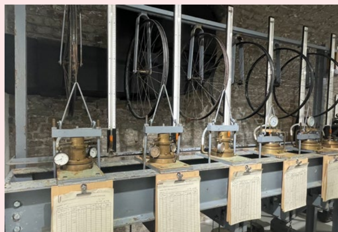
Slika 1: Prvi edometrijski aparati (Vir: Hana Huth Lukšič)
